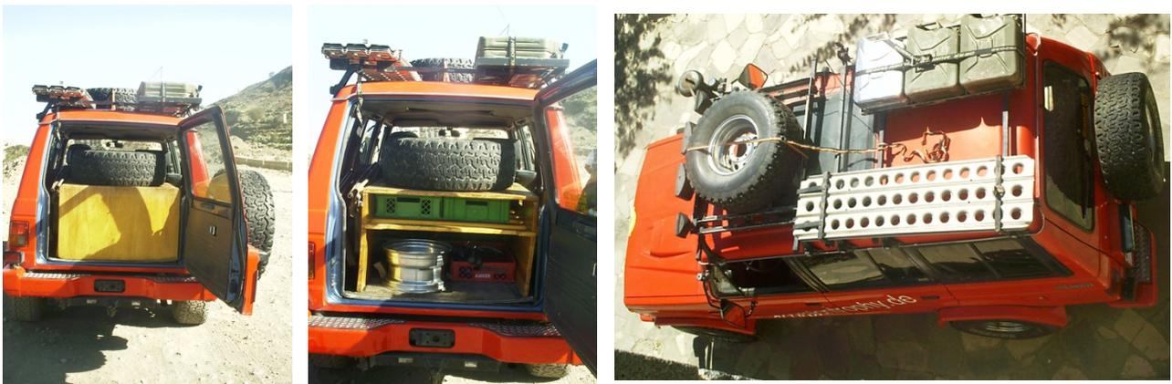
**Der Multifunktionsstapelpaul mit Campingtisch und Regalkonstruktion - Aluminiumdachkonstruktion mit Kanistern, zweitem Ersatzreifen und Patentsandblechhalterung**
